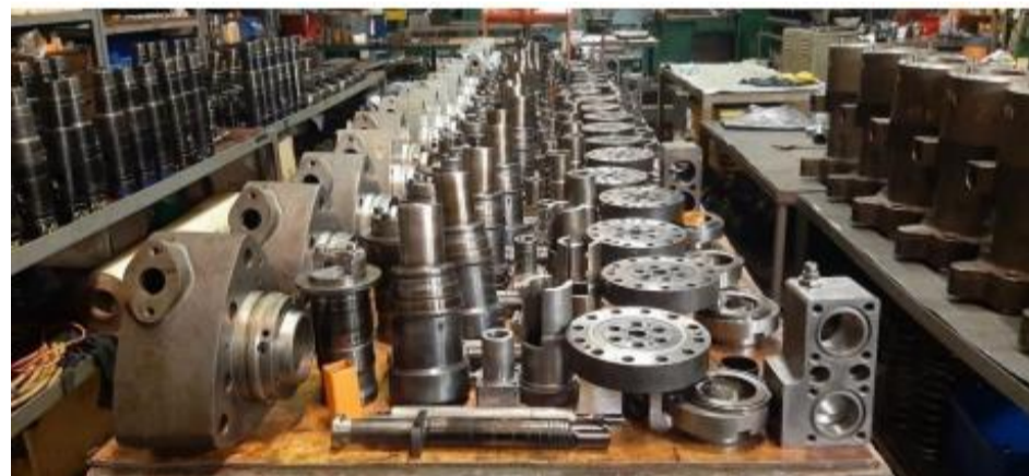
Rys. 3. Zdjęcie czystych elementów pomp wtryskowych przygotowanych do weryfikacji
