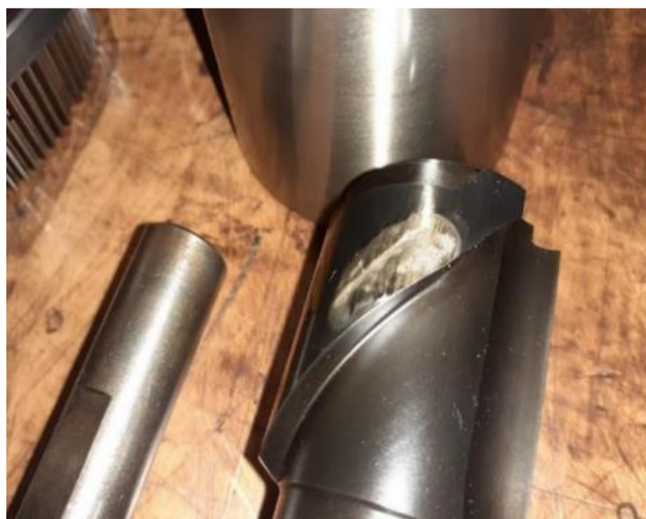
Rys. 4. Zdjęcie uszkodzeń na tłoku pary precyzyjnej
