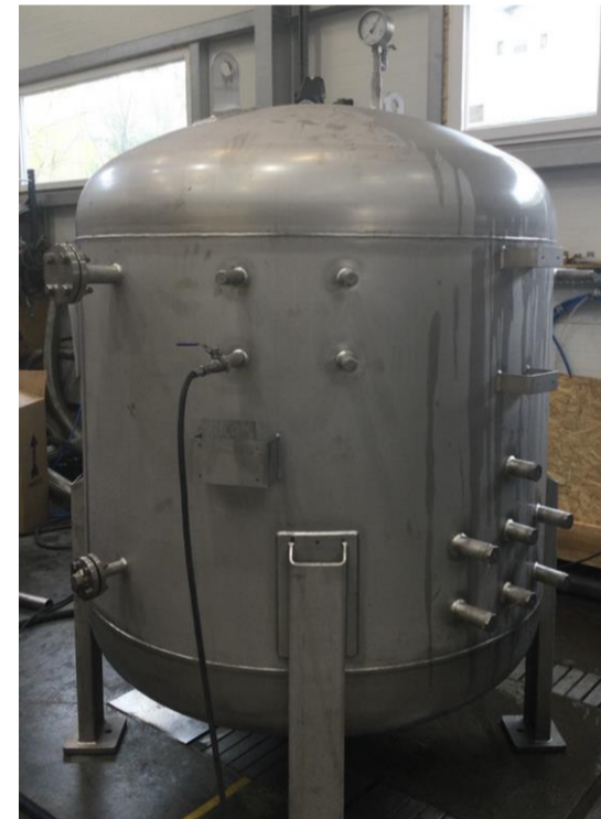
Rys. 2. Zdjęcie projektowanego zbiornika podczas próby ciśnieniowej
