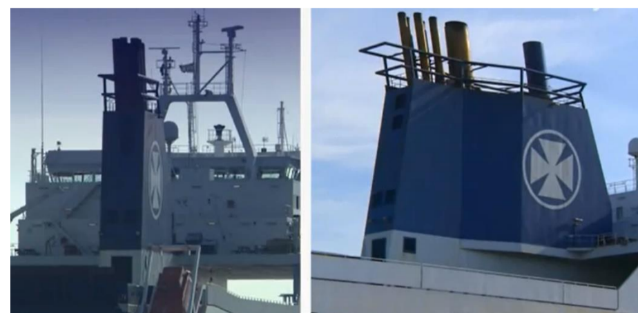
Rys. 3. Komin przed i po przebudowie
