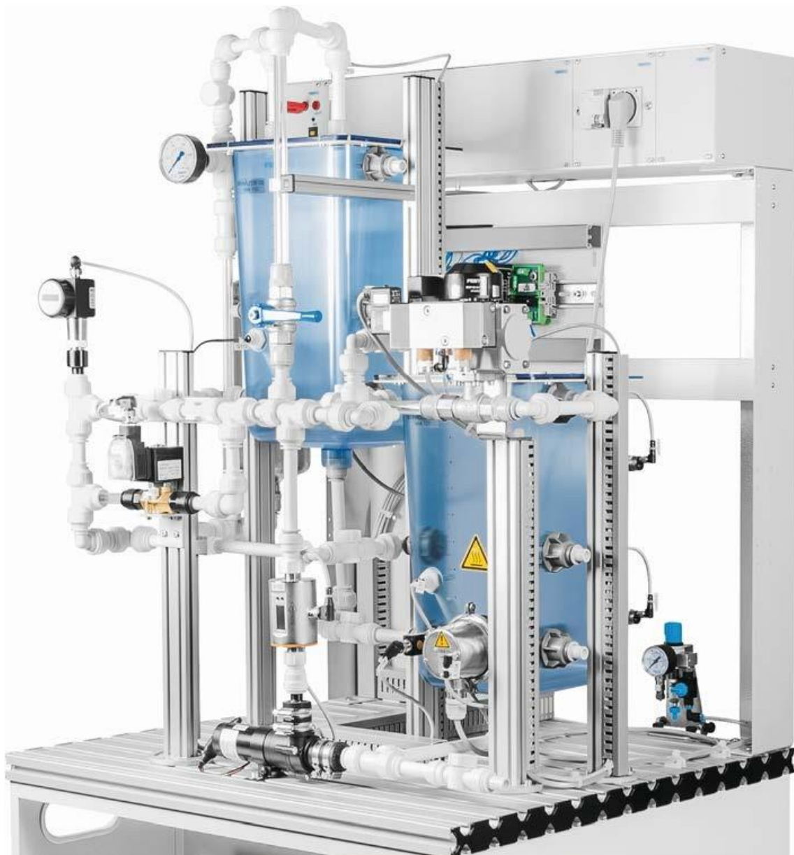
Rys. 2.1 Stanowisko modułowe układu zbiorników
