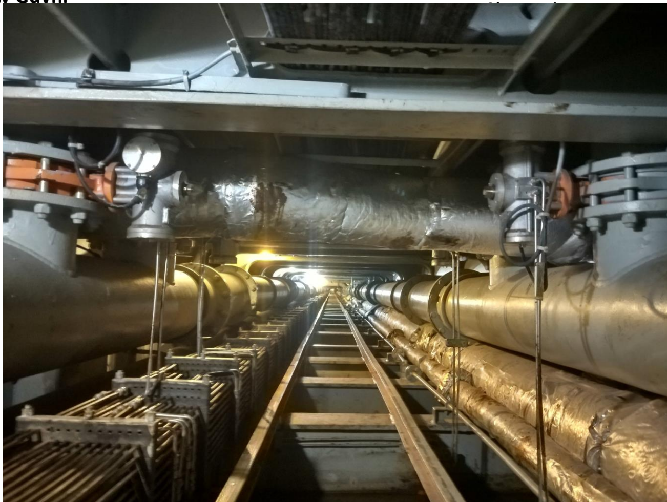
Rys. 7 Tunel w dnie podwójnym statku
