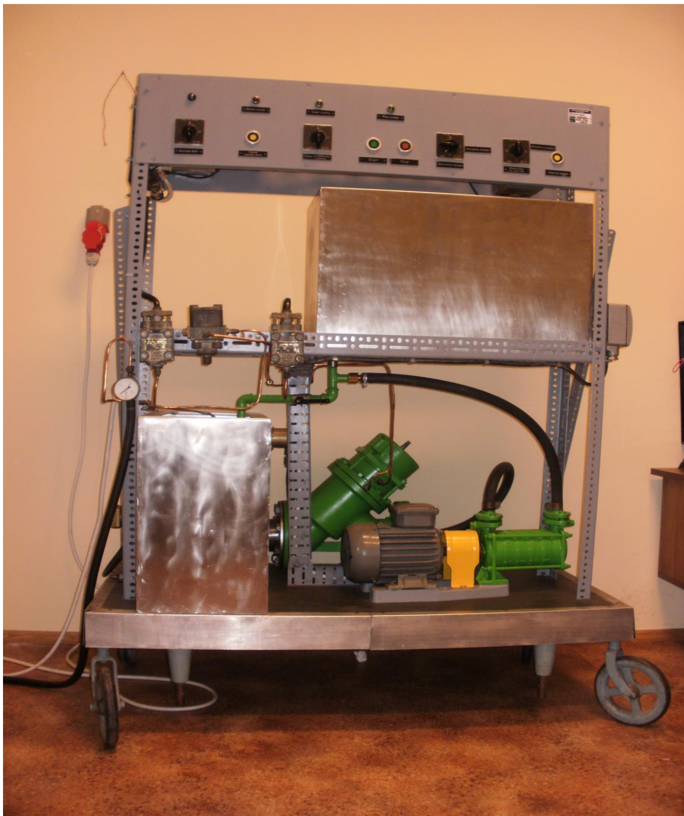
Rys.15. Stanowisko badawcze układu sterowania instalacją zęzowo-balastową
