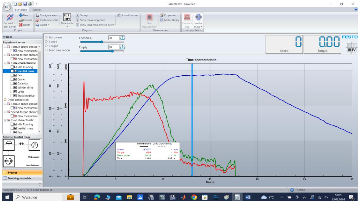
Rys. 4.14 Charakterystyka dynamiczna rozruchu i zatrzymania silnika trójfazowego z obciążeniem inercyjnym, połączenie Y
